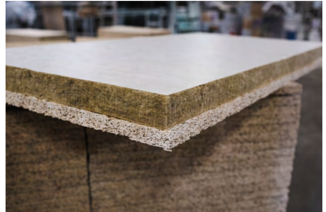
Träullit Kombi kombinerar vår högpresterande Träullit Akustik med kompletterande mineralull eller polyesterfiber som fästs eller placeras på skivans baksida. Detta resulterar i en produkt med samma byggtkniska egenskaper som Träullit har kommit att bli synonyma med samt en ljudabsorptionsförmåga av allra högsta klass.
