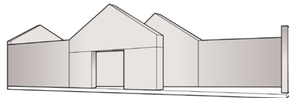
De objektspanpassade väggelementen gjuts och prefabriceras på Trällits fabrik efter kundens särskilda önskemål och byggprojektets specifikationer.
