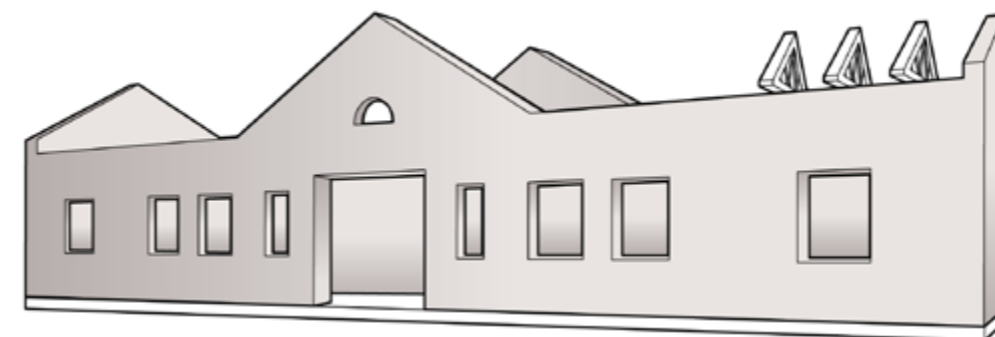
Ytterväggarna monteras och eftergjuts sedan på mindre än en dag vilket ger i en mycket kort byggnationstid. Detta möjliggör för en högfunktionell ytterväggskonstruktion, med flera exceptionella byggtekniska fördelar, till en låg totalkostnad.
